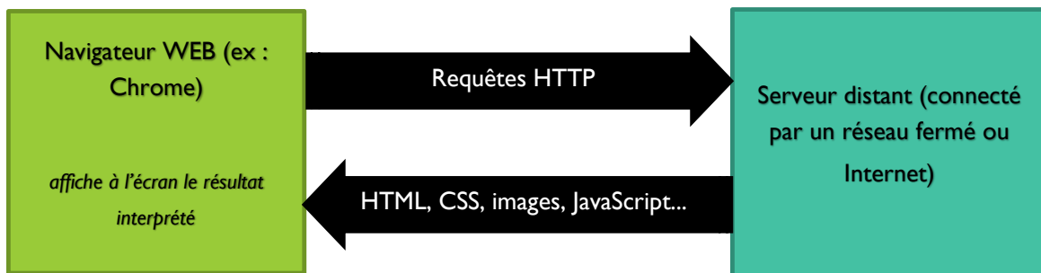
Figure 9 : Principe de fonctionnement d'une requête HTTP
